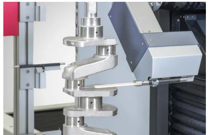
Kurbelwellentastarm für Form- und Durchmessermessung
