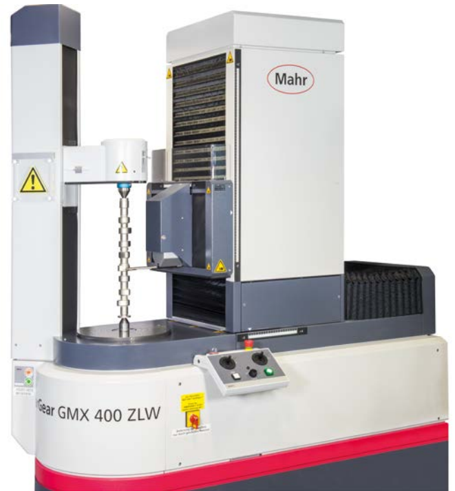
Nockenwellenmessung auf MarGear GMX 400 ZLW
