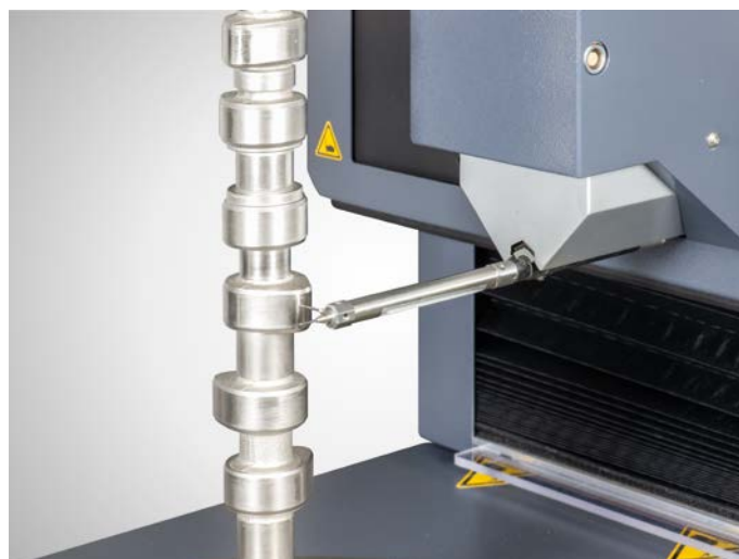
MarGear GMX 400 W: Nockenwellenmessung mit abgeköpftem Tastarm
