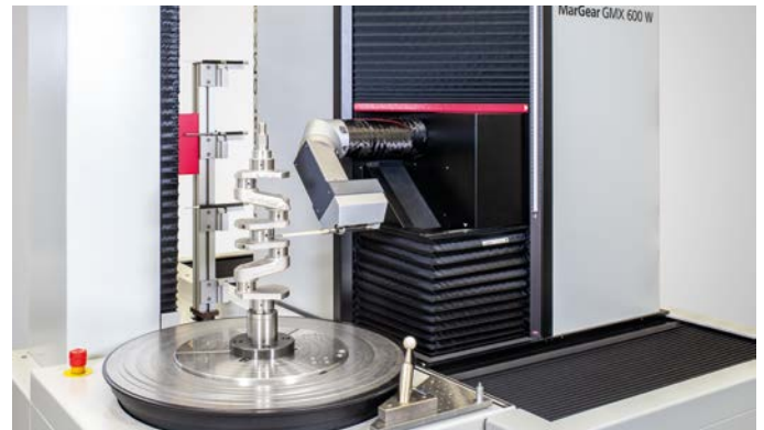
MarGear GMX 600 W mit XXL-Tisch zur Kurbelwellenmessung
