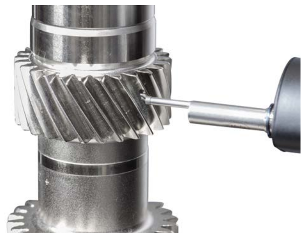
Rauheitsmessung an einer Schrägverzahnung
